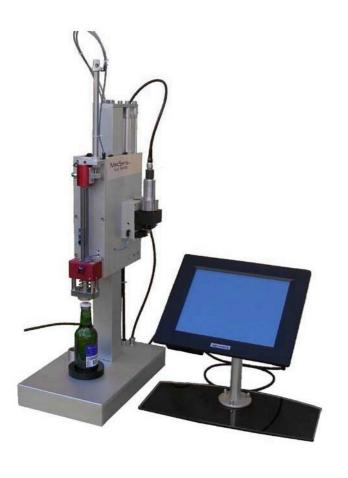
瓶颈及饮料中的氧含量。模块化设计的概念,使它可以升级为 GASCHECK plus®以增加瓶颈及饮料中二氧化碳与氮气的测量。经由高精密的微通道流量取样室,精确的分析瓶颈体积,并体现美胜的工程与瑞士精密制造的能力。
