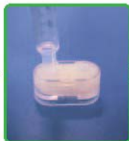
注入试样后,将注射器留在孔中,约一半试样会流到另一侧
