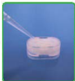
在 Lepicuve 一边的孔内注入试样
